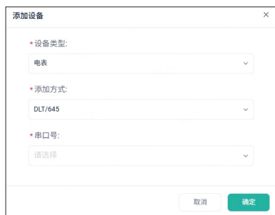
图 6-14 通过 DLT/645 协议添加电表
